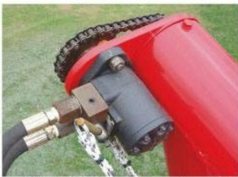
Motor hidráulico con multiplicador de velocidad.
