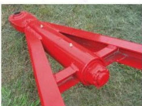
Punta de lanza con sistema compensador.
